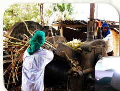
Colmo prensado pelas moendas nos engenhos para obtenção do caldo de cana e posteriormente seus derivados
