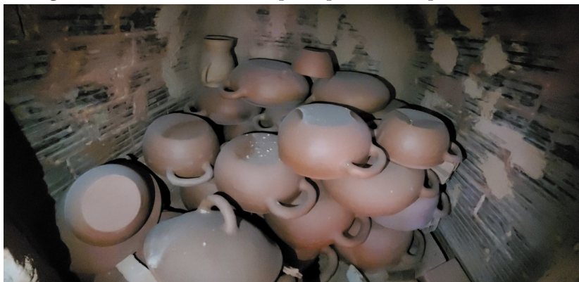
Figura 12. Peças de cerâmica após o processo de queima no forno
