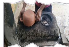
Processo de defumação da peça para torná-la antiaderente
