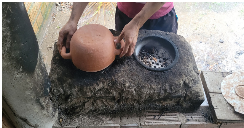
Figura 13. Processo de defumação da peça para torná-la antiaderente.
